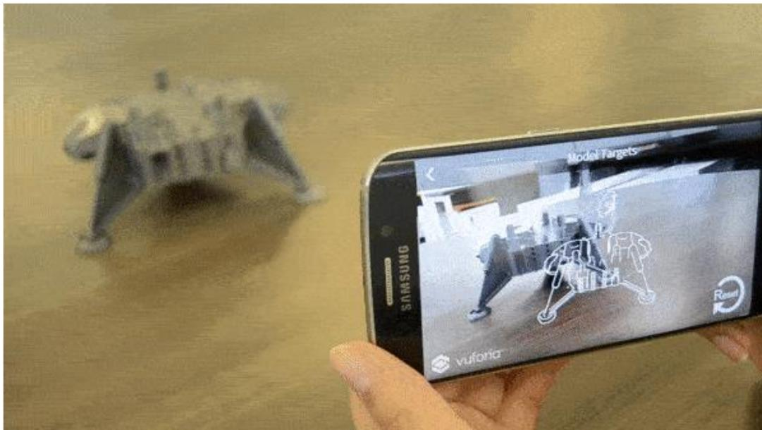
Рассматриваемый способ **reco/track (Model Target)** требует, чтобы пользователь держал свое устройство под определенным углом относительно реального объекта и на определенном расстоянии, чтобы начать отслеживание **Model Target**. Чтобы облегчить этот процесс, Приложение ДР, использующее этот метод **reco/track**, как правило, «рисует» в области отображения смартфона/мобильного устройства контурное изображение обнаруживаемого/распознаваемого объекта, показывающее
