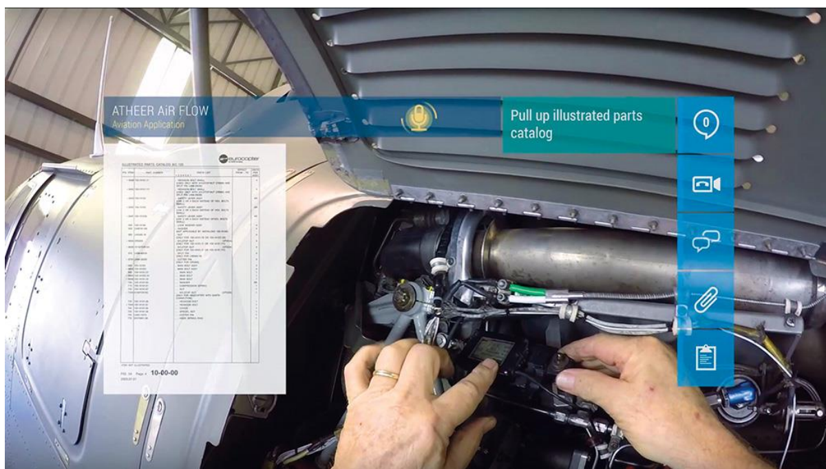
Рис.4. Применение дополненной реальности при выполнении работ по обслуживанию и ремонту вертолётного двигателя (по данным компании Atheer)
