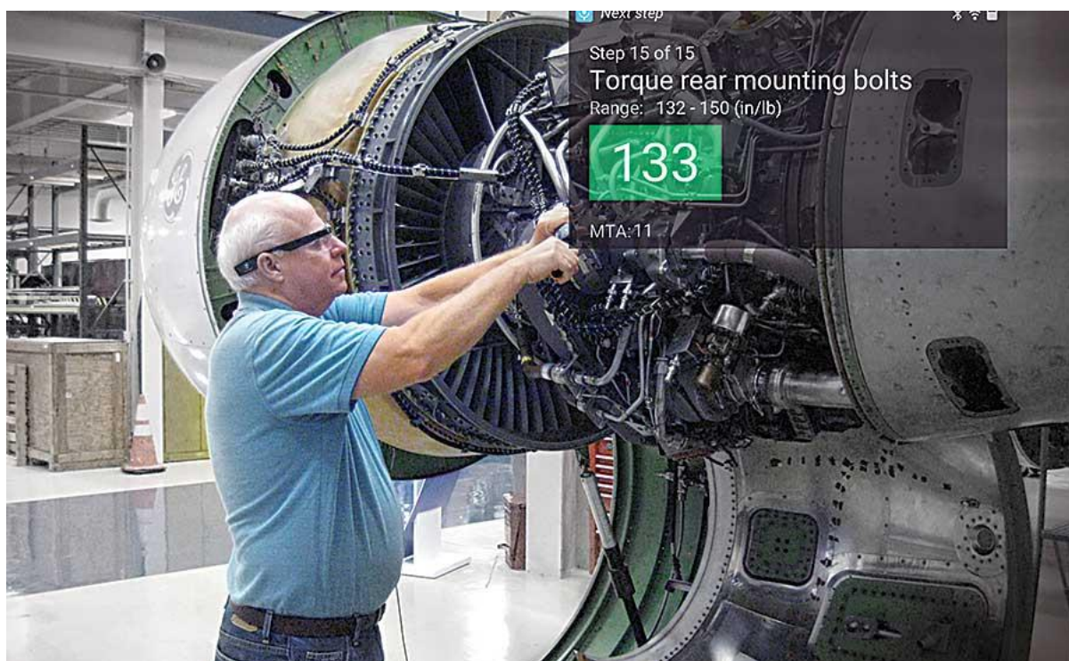
Рис.1. Применение очков дополненной реальности для доведения пошаговых инструкций при проведении сложных работ. (по материалам GE и Upskill)
