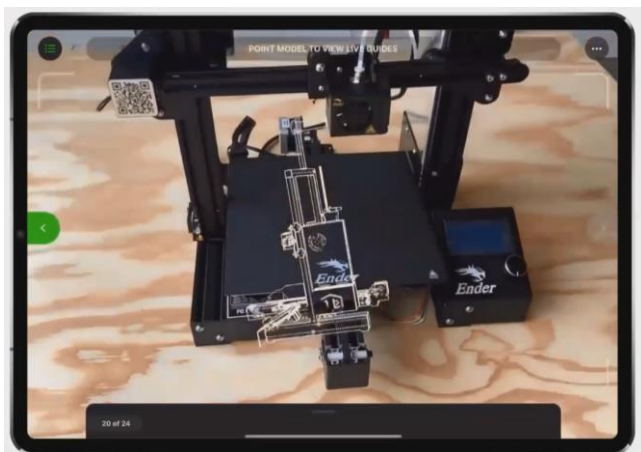
Рис. 2. Пример работы приложения Vuforia Instruct
