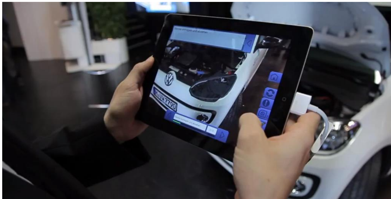
Рис.5. Проект MATRA: визуализация инструкций по монтажу-демонтажу светотехнического оборудования автомобиля XL1
