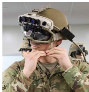
Рис. 1. Носимое наголовное устройство — очки дополненной реальности HoloLens в военном полевом исполнении — Integrated Visual Augmentation System (IVAS) (источник — Microsoft)
