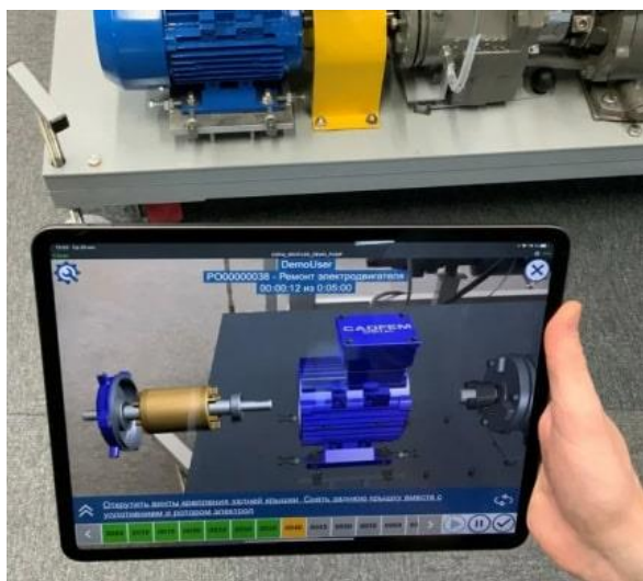
Рис. 6. Применение ServiceVizor : AR для ТОиР электродвигателя
