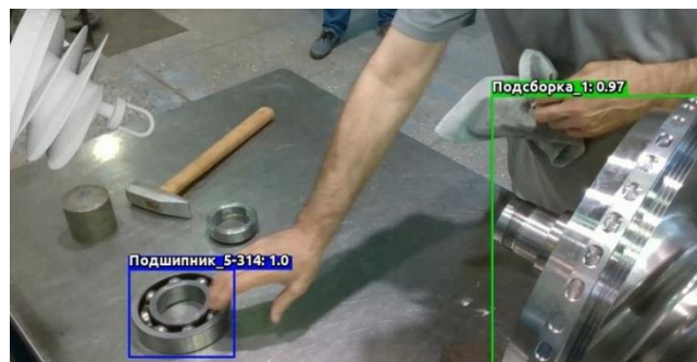
Рис. 3. AR-технология контроля ручных операций по видеоизображению от ООО "Мотив НТ", АО "НПО Энергомаш" и ФГУП "ВНИИА"
