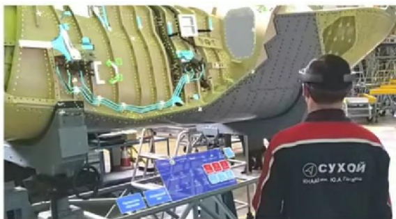
Рис. 5. Информационное сопровождение выполнения операций на рабочем месте. Постоянный контроль по 3D-модели и интерактивное выполнение пооперационных инструкций
