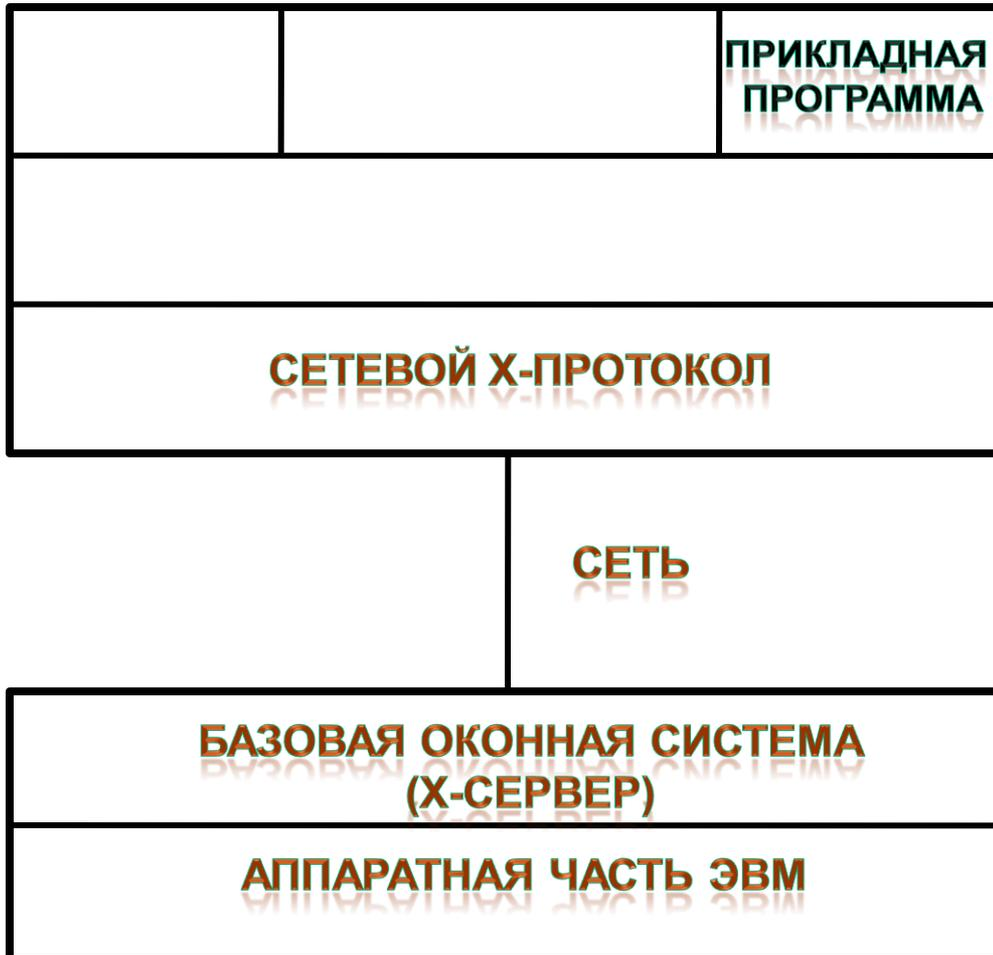
Архитектура X, как и большинства других систем, предназначенных для работы в сети ЭВМ (не только оконных), базируется на модели **клиент-сервер**.
