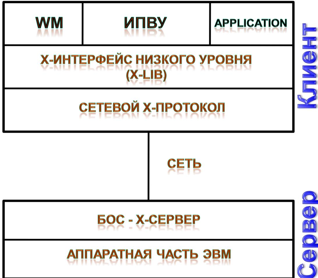
Интерфейс, предоставляемый конечному пользователю, является комбинацией возможностей **X-сервера**, **инструментального пакета (ИПВУ)**, **диспетчера окон (WM)** и собственно **прикладной программы (Application)**.
