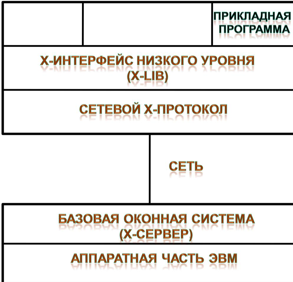
Обычно прикладные программы не используют для взаимодействия с сервером **X-протокол** непосредственно, а работают с подпрограммами из **библиотеки Xlib**.
