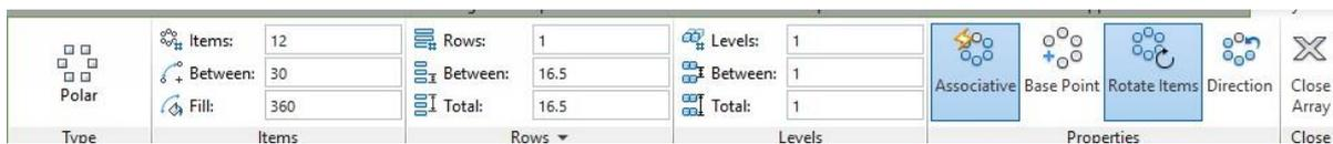
Рис. 7.6. Задание параметров массива (Circle) во вкладке – Создание массива
