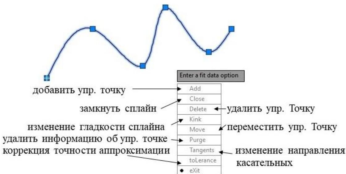
**Рис. 5.19. Диалог команды Splinedit в режиме редактирования определяющих вершин**
