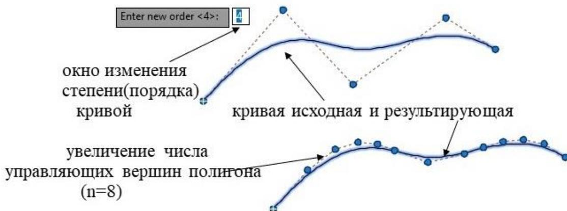
**Рис. 5.23. результат пересчета кривой при увеличении ее порядка**
