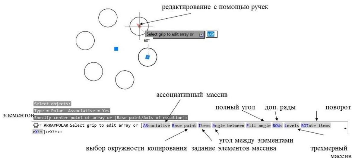
**Рис. 5.11. Возможности создания и редактирования кругового массива**
