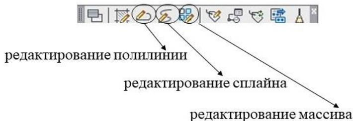
**Рис. 5.2. Панель инструментов MODIFY II**
