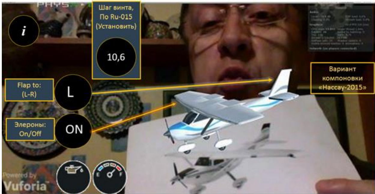
Рис.4. Просмотр AR-объекта путем сканирования мобильной Web-камерой метки. На экране мобильного устройства - наложение AR-объекта на визуальное поле и перемещение AR-объекта вслед за перемещением метки. Автоматически в визуализационное поле транслируются текущие значения параметров объекта и элементов управления характеристиками модели.
