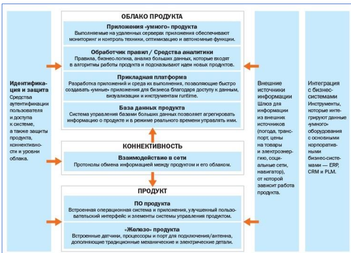
Рис.1. Функциональная структура платформы промышленного интернета вещей.
